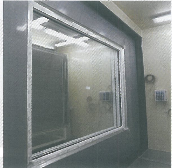
<사진 2> 열관류율 저온측 시험체 모습
