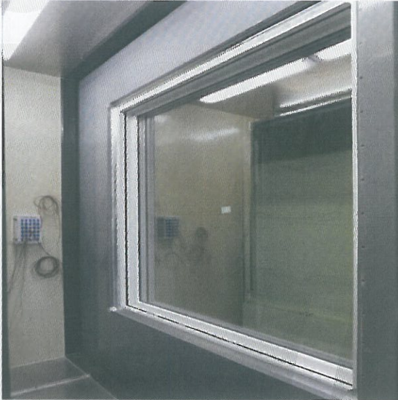
<사진 1> 열관류율 항온측 시험체 모습
